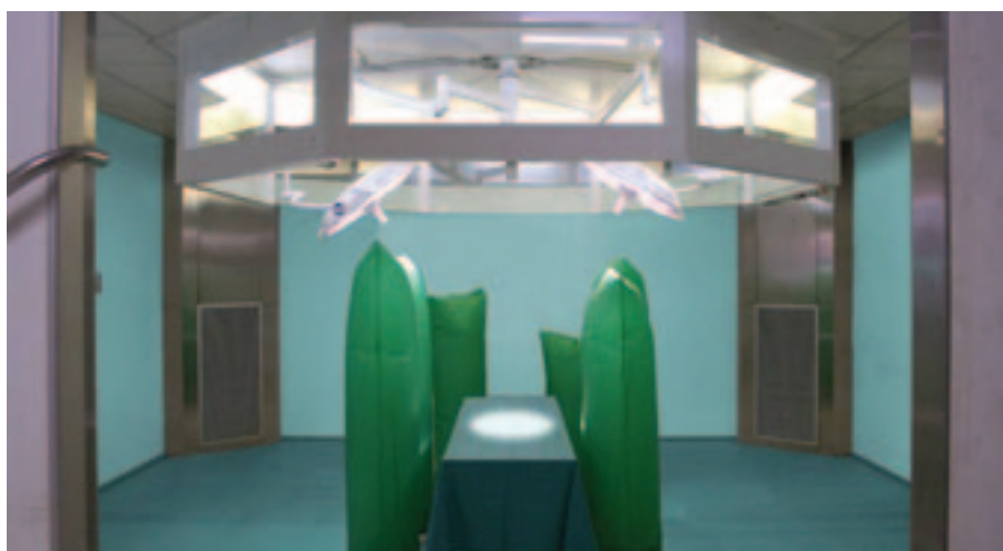
„OP- Testraum zur Durchführung der Dichtheitsprüfung und Partikelmessung- Ermittlung Abscheidegrad und Schutzgradwirkung gem. VDI 2167 (Entwurf)“
